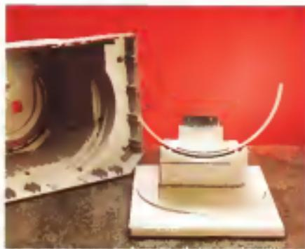
Ecco come si presenta lo snodo che permette la «tilt» in condizioni operative: la fascia plastica semicircolare che appoggia sulle lami e si avvitano al corpo del monitor, mentre la piastrina metallica posteriore è ancorata mediante una guida che scorre in una fessura del cabinet.
